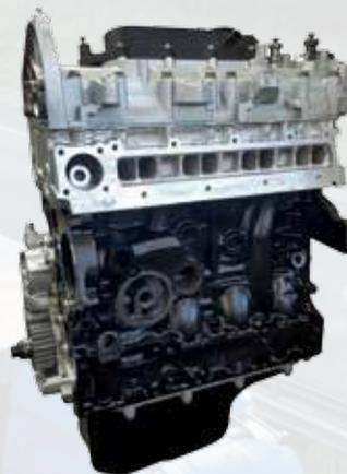
Un motore revisionato semicompleto Fiat/Iveco F1AE: kit motore con testata completa, coppa olio e coperchio punterie (mancano tutti gli accessori come collettori, turbina, distribuzione, iniezione...)
